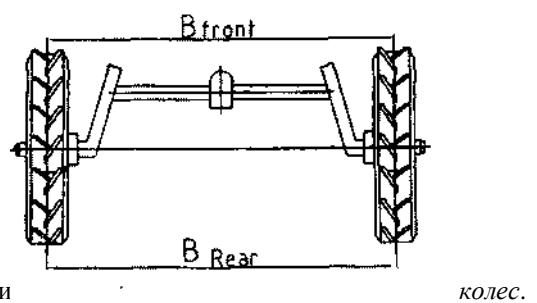
Рис. 5. Настройка схождения передних колес.
