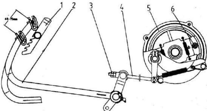
Рис. 12. Механизм тормоза..
