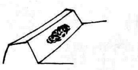
прокладки картера ведущего моста пригодной толщины, чтобы убедится в правильности отпечатка (как показано на рисунке) и размером зазора в пределах 0.16 – 0.32 мм. Тем временем, удерживайте предварительное напряжение на обоих концах дифференциала в пределах 100—150 Н;
